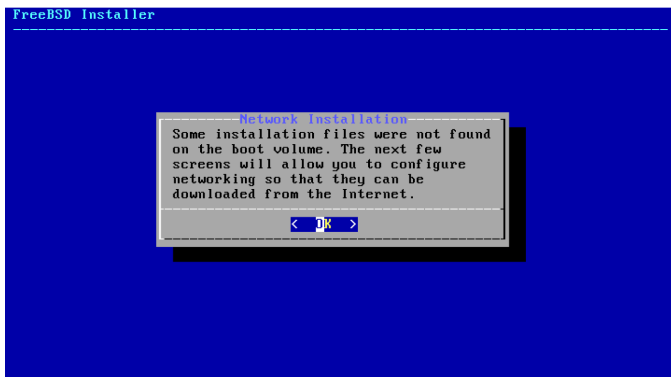
Figure 9. Installation à partir du réseau
